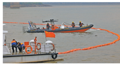
多功能溢油处置船在溢油区域开展溢油处置。 记者 李文静 摄
