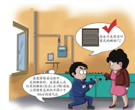
**8** 安装嵌入式灶具的橱柜(灶台正(侧)面板)上须留有总面积不得小于80cm<sup>2</sup>的通气孔。通气孔必须与厨房内大气相通。
