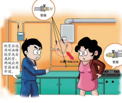
**7** 燃气管应选用耐油橡胶软管或金属软管，其长度不得超过2米，软管两端应用管箍安装牢固;严禁软管穿墙、门窗等;经常检查软管是否出现老化、龟裂、脱落等现象，发现异常应立即更换。
